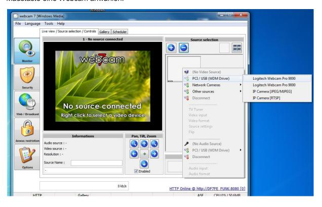
Wenn ein Bild erscheint, ist bereits die größte Hürde genommen. Falls die Kamera steuerbar ist ("Pan, Tilt, Zoom") kann diese Funktion über den Button "Enablen" aktiviert werden. Gibt die Webcam oder der zugehörige Treiber diese Möglichkeit nicht her, sollte der Haken entfernt werden (schadet aber auch nicht, wenn die Möglichkeit dennoch aktiviert).
