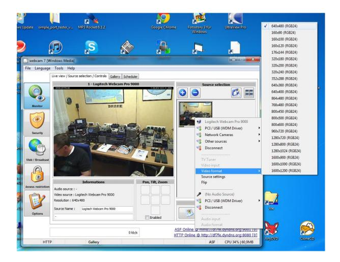
Mit rechter Maustaste auf "PCI/USB (WDM Driver)" kann eine (beliebige) Soundquelle dem Videostrom mitgegeben werden. Kommt das Audiosignal vom heimischen Transceiver gelten die gleichen Spielregeln wie bei den digitalen Betriebsarten. Also: galvanische Trennung der Soundkarte und des Signalausgangs bei moderater Lautstärke.
