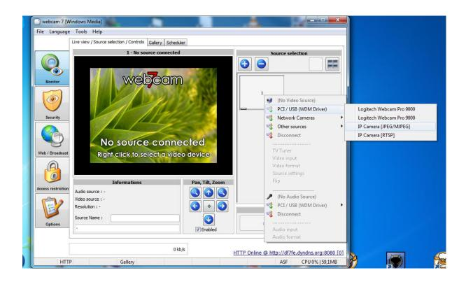
Im Menuepunkt "Source Settings" das Modell (oder kompatibles Modell) wählen (d.h. Hersteller/Typ/Modellbezeichnung und ggf. Pan/Tilt/Zoom-Option) und mit "OK" bestätigen.
