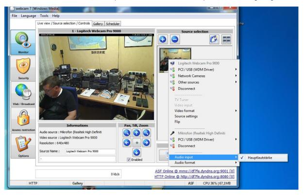
Mit rechter Maustaste auf "Audio Format". Dort kann das gewünschte Übertragungsformat gewählt werden. Normalerweise ist die Defaulteinstellung ok und muss nicht verändert werden. Eine HIFI-Übertragung kostet nur unnötig Bandbreite und ist überflüssig.
